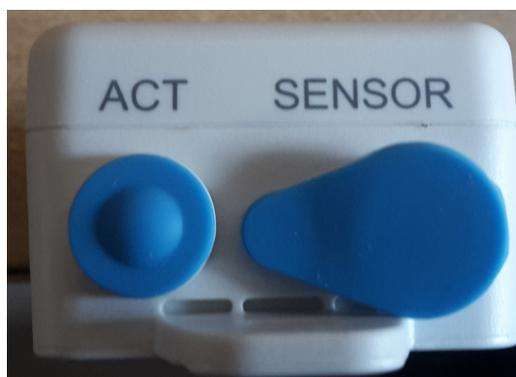
FIGURE 5 – Bouton ACT et slot de branchement du thermomètre du capteur LHT65
